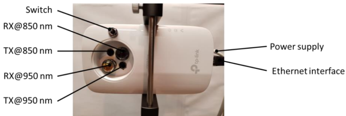
Figure 6. PLC plug “tp-link” - AV 1300 Gigabit modified
